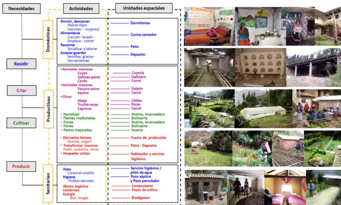
Figura 2. Nuevo sistema habitacional en la vivienda campesina de altura
